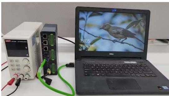
2. 稳压电源设置为 24V/1A，网线连接 ZMC600E 控制器的 NET1 和测试电脑的网口。打开电源，给 ZMC600E 控制器供电。
