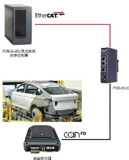
除了实现 CANFD 到 EtherCAT 的转换，PXB-8020 产品同时支持将 CAN 信号转换为 EtherCAT，车机 CAN 数据系统同样可以通过转换无缝接入 EtherCAT 主控系统。
