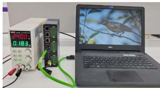
3. 测试电脑 IP 设置为 192.168.1.168，并通过 ping 包工具确认可以 ping 通 ZMC600E 的 NET1 的 IP 地址：192.168.1.136。
