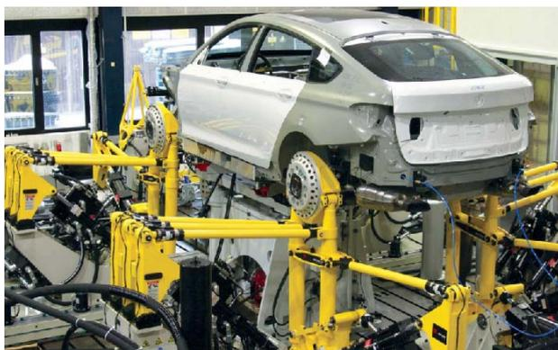
当以上测试系统需连入汽车底盘数据时，往往测试系统无法直接通过 EtherCAT 网络读取，因为底盘控制器采用 CANFD 传输信号。
