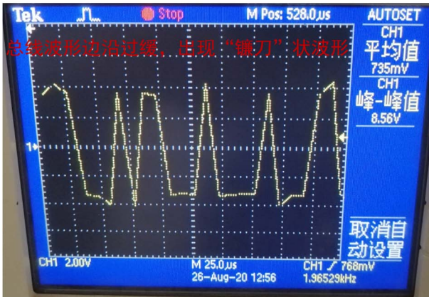
图10 485总线“镰刀”波形
