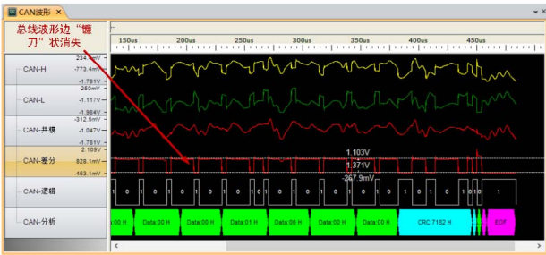
图7 去掉全部TVS管后总线波形
