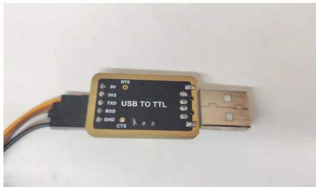
将 MPC-ZC1 开发板引出的 TX2 与 RX2 分别与 usb 转 TTL 串口工具的 RX 与 TX 连接, 并将 usb 转 TTL 串口工具插到 pc 机 usb 口上。至此, 准备工作已经完成。
